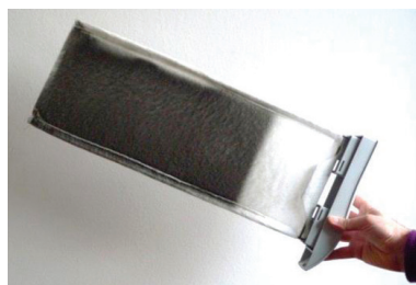
Figura 27 - Esempio di filtro sporco usato nei sistemi VMC
