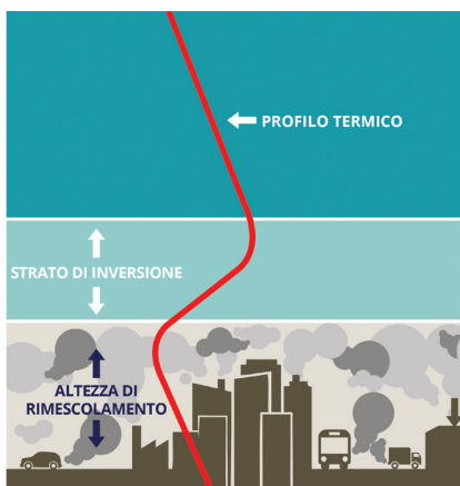
Figura 1 – Variazione della temperatura con l'altezza durante il periodo invernale. Lo strato di inversione è caratterizzato da un aumento della temperatura con l'altezza che comporta il ristagno degli inquinanti al di sotto (strato di rimescolamento)
