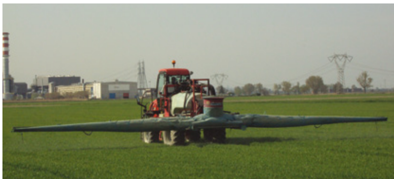
Barra irroratrice con manica d'aria attiva
