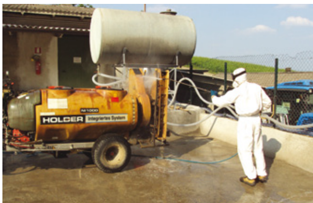
Lavaggio dell'irroratrice nell'area attrezzata
