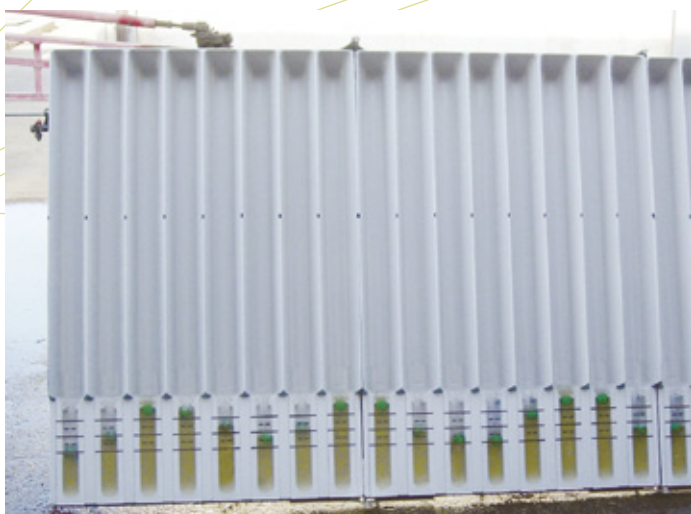
Verifica del profilo di distribuzione di una barra
