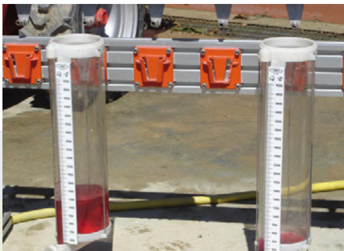
Misurazione della portata degli ugelli
